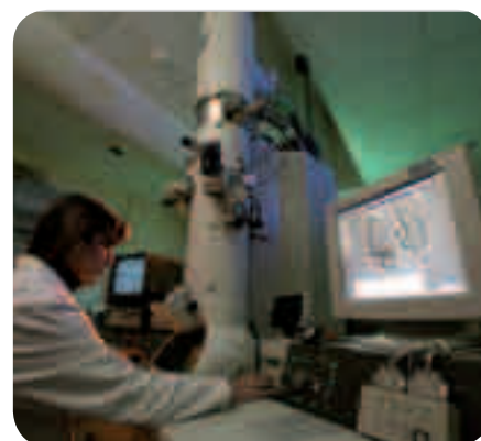
La cryomicroscopie électronique permet d'obtenir des images de complexes protéiques (virus, protéines...).
