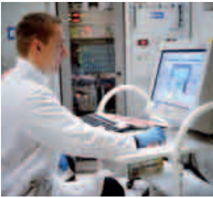
Pupitre de commande du cyclotron, permettant la production de radiopharmaceutiques.
