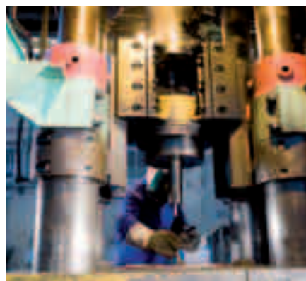
Installation de filage de tubes pour les gaines d'acier ODS (4 e génération) et pour certaines études innovantes sur le gainage combustible des REP.
