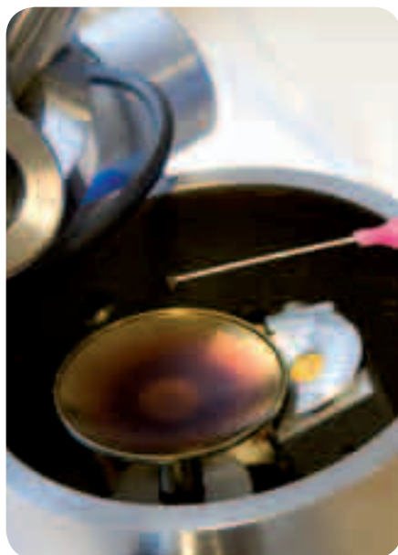
Bâti d'assemblage des cibles préparées pour la LIL et le futur LMJ.
