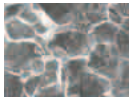
Rupture intergranulaire de matériau de vis d'interne REP. Haut : vis d'interne. Bas : faciès intergranulaire.
