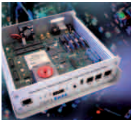
Circuit multiprocesseurs basse consommation pour la téléphonie 4G.
