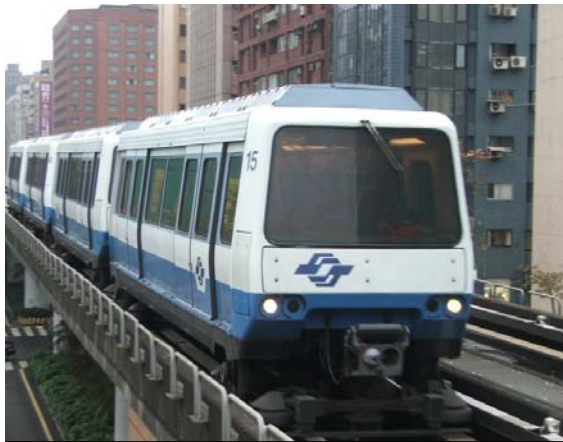
Rames SIEMENS VAL 256 en exploitation sur la Muzha Line
