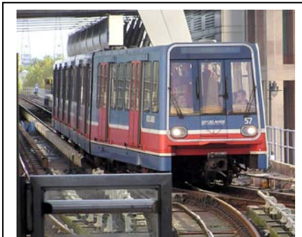
Le Docklands Light Railway (Londres) est le seul système dont le matériel roulant d'origine (1987) était dérivé d'un tramway. Ces premiers véhicules ont d'ailleurs été rachetés et reconfigurés par le réseau de tramway d'Essen (Allemagne).
