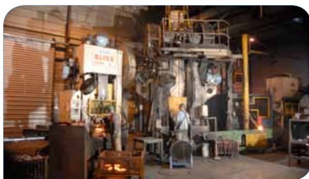
Poste de forgeage équipé d'une chauffeuse à induction à Nogent
