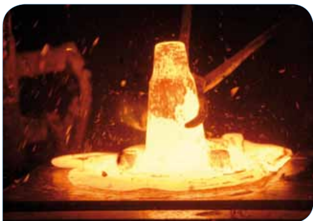
Fusée d'engin agricole en cours de forgeage
