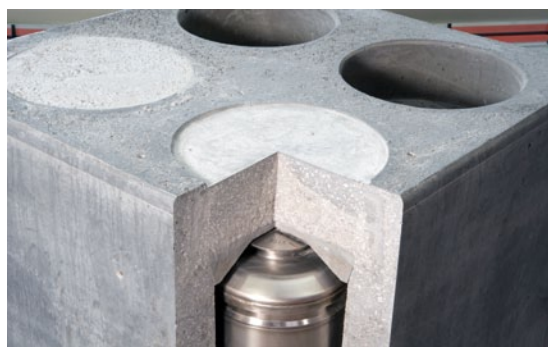
Démonstrateur de conteneur en béton pour des colis MA-VL
