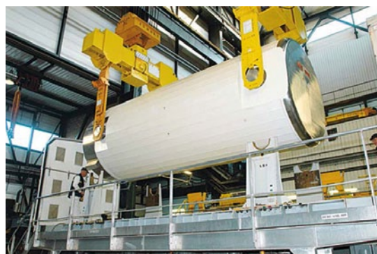
Pour leur transport, les déchets HA sont placés dans un emballage de transport
