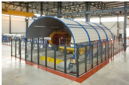
Démonstrateur technologique de manutention de colis HA et de sa hotte de transfert
