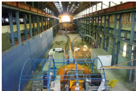
Essai de retrait d'un colis HA dans une alvéole fortement déformée
