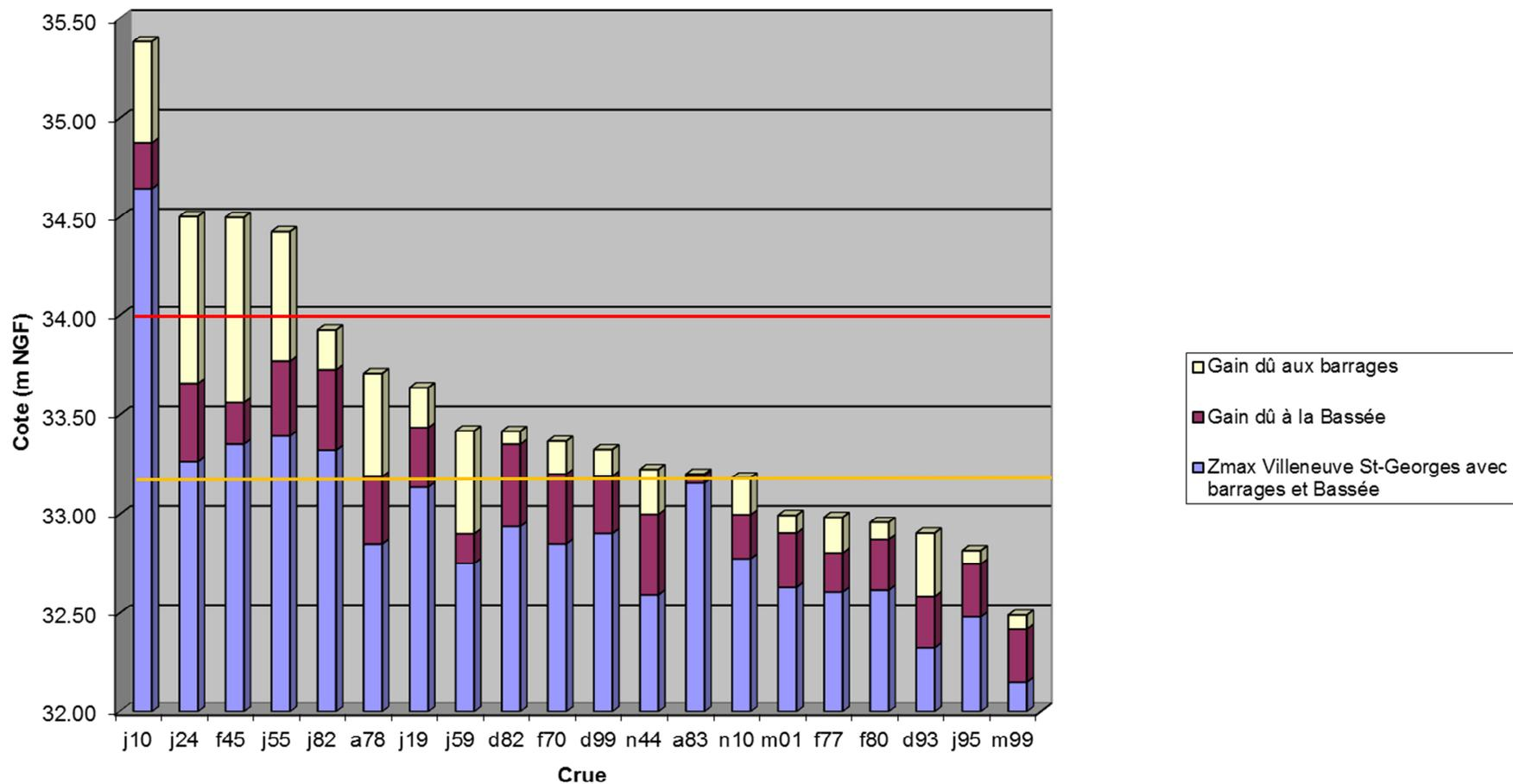
Figure 3-6 : Impacts des barrages et de l'aménagement Bassée sur les cotes maximales obtenues pour chaque crue à Alfortville
