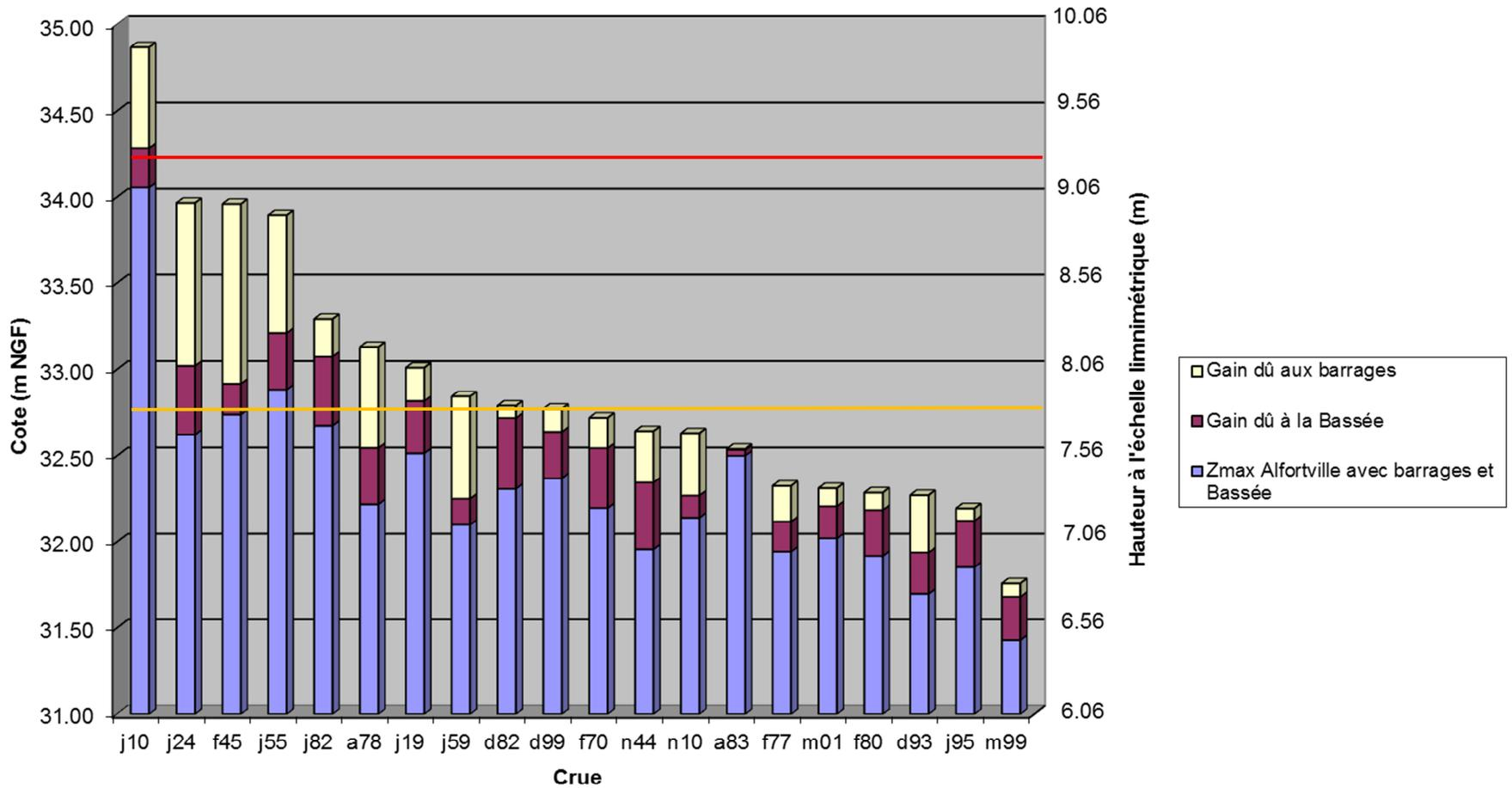
Figure 3-7 : Impacts des barrages et de l'aménagement Bassée sur les cotes maximales obtenues pour chaque crue à Paris
