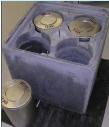
Conteneur commun d'entreposage de longue durée-stockage pour déchets MA-VL
