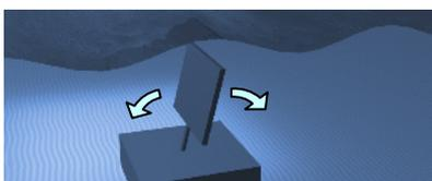
1) de type « oscillateur » : un volet monté sur un bras articulé oscille avec les vagues
