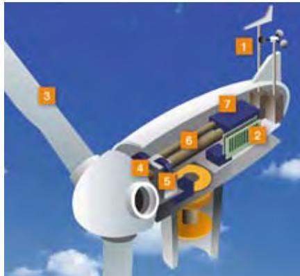
Grâce à la girouette (1) située à l'arrière de la nacelle, l'automate (2) commande aux moteurs d'orientation de placer l'éolienne face au vent dès que celui-ci se lève. Les trois pales (3) sont mises en mouvement par la seule force du vent. Elles entraînent avec elles l'axe lent (4), le multiplicateur (5), l'axe rapide (6) et la génératrice (7).
