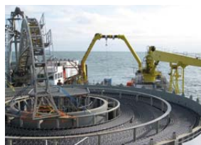
Un navire câblé est utilisé pour dérouler le câble en mer
