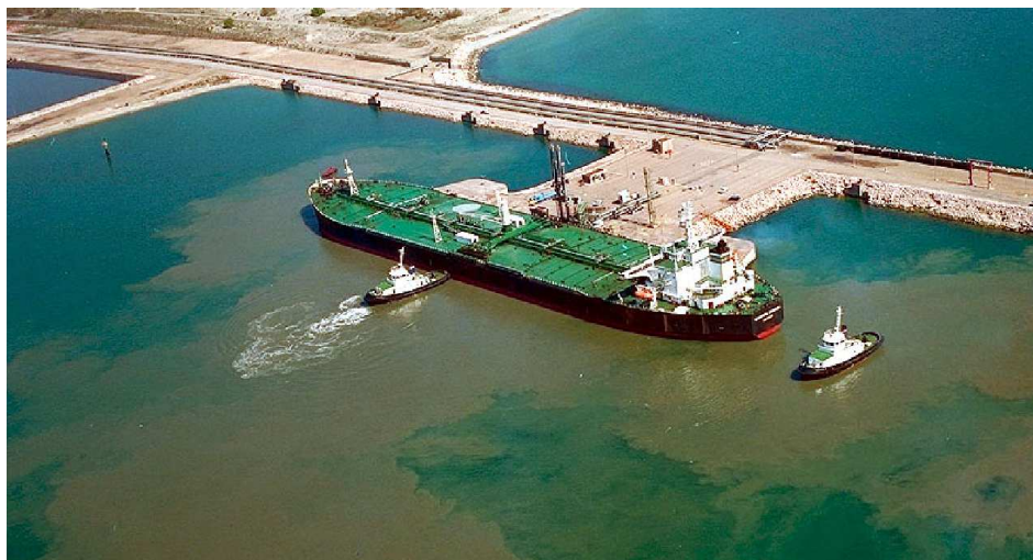
Illustration 2 : Panache turbide engendrée par les manœuvres des navires
