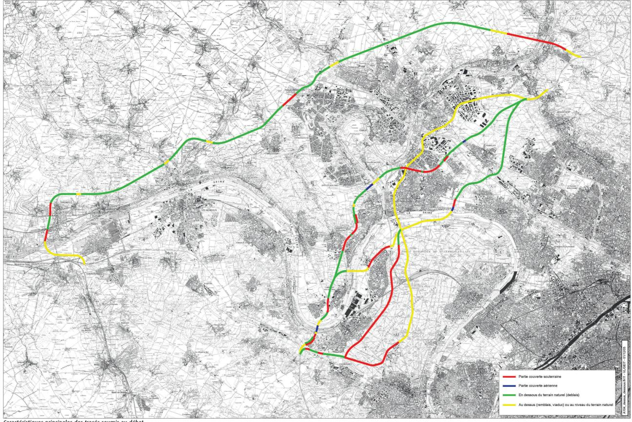
Caractéristiques principales des tracés soumis au débat. Le projet est constitué d'une route à chaussées séparées, comprenant chacune deux voies et pouvant être élargies à trois voies.
