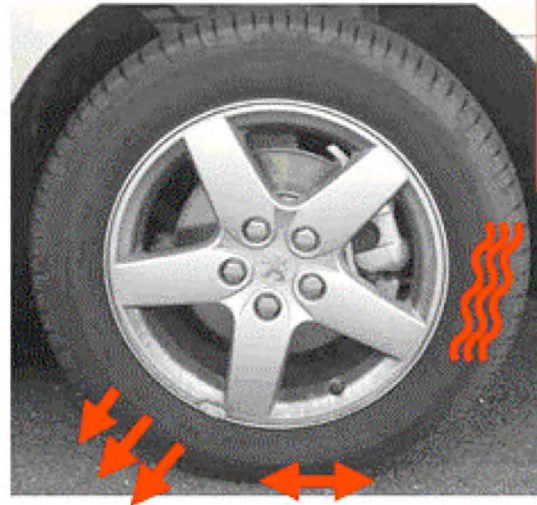
Vibrations transversale et radiale des flancs et de la bande de roulement
