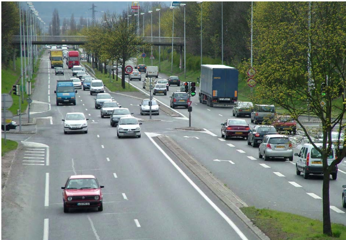
n° 56. carrefour RN184 - bd de la Commune de Paris Carrefour type dans la traversée d'Eragny avec le traitement des " tourne à gauche " à l'indonésienne.
