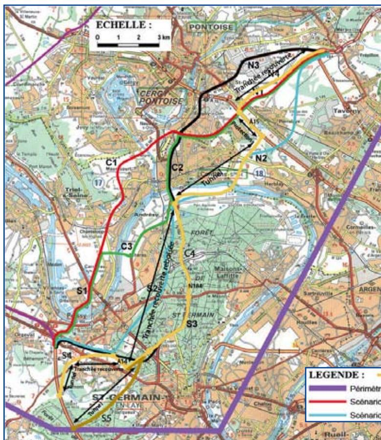
*Le tracé jaune proposé par l'APSO, tout en tranchée couverte et en tunnel, évite le raccordement à Orgeval, au sud.*
