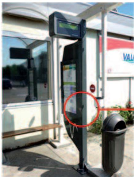
*Ce dispositif encore expérimental permet, à la demande, de donner en sonore les temps d'attente donnés par l'afficheur, des prochains bus qui vont passer à l'arrêt. Il peut être disponible à certains ou à tous les arrêts équipés d'un afficheur d'une ligne. En cela, il double l'information visuelle donnée par l'afficheur.*
