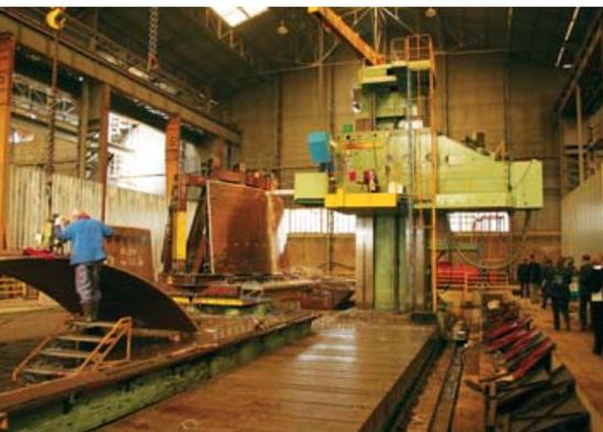
La production couverte par les CMP Arles concerne des appareils, de type réservoirs ou skids, dont les dimensions dépassent classiquement 9 mètres de diamètre, 50 mètres de longueur et des poids fréquemment de plusieurs centaines de tonnes.
