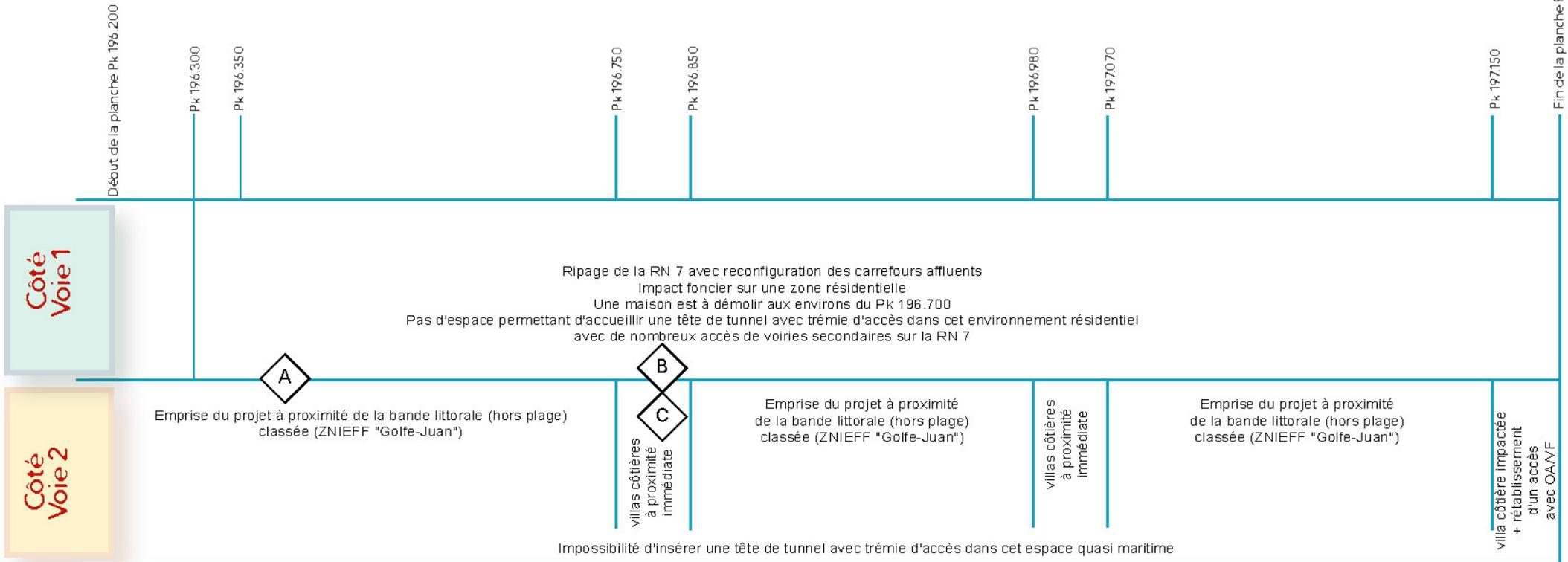
Si l'analyse des contraintes montre que l'on peut insérer une troisième voie, sur ce secteur on ne peut pas techniquement insérer une tête de tunnel sans un impact fort sur le milieu naturel ou humain (franchissement de ce secteur en tunnel)
