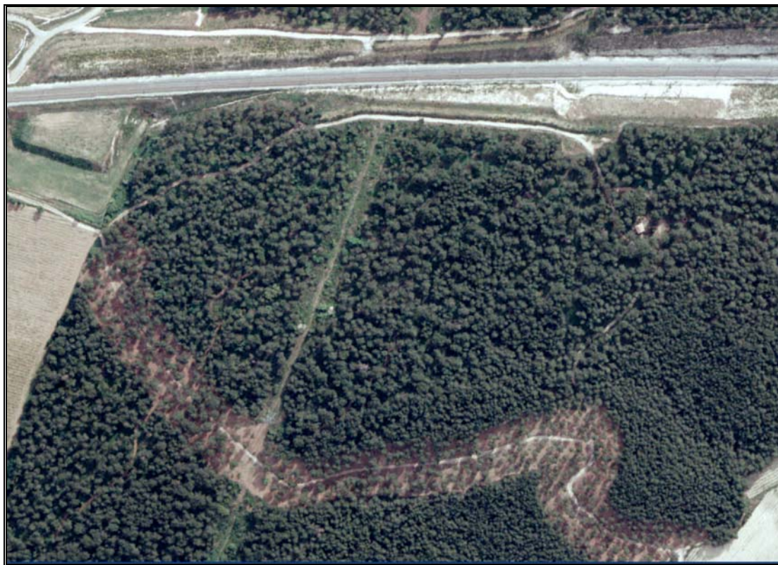
Débroussaillage alvéolaire à proximité de la LGV
