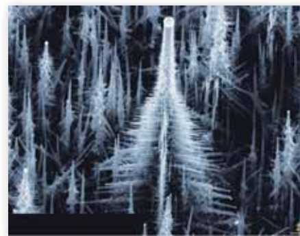
Arborescence de nanofils de silicium
