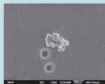
Petit agrégat compact (~ 200 nm) de nanoparticules (~20 nm) de dioxyde de titane
