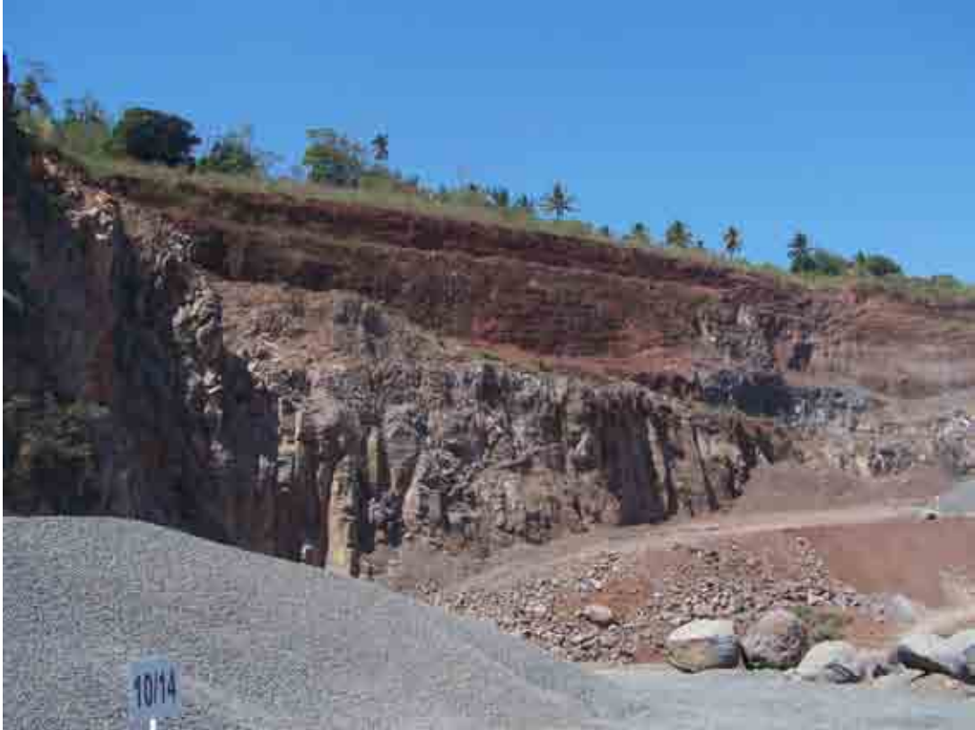
Photo 6 : Carrière de Pamandzi - Front de taille montrant la superposition basalte gris et matériaux scoriacés altérés rouges
