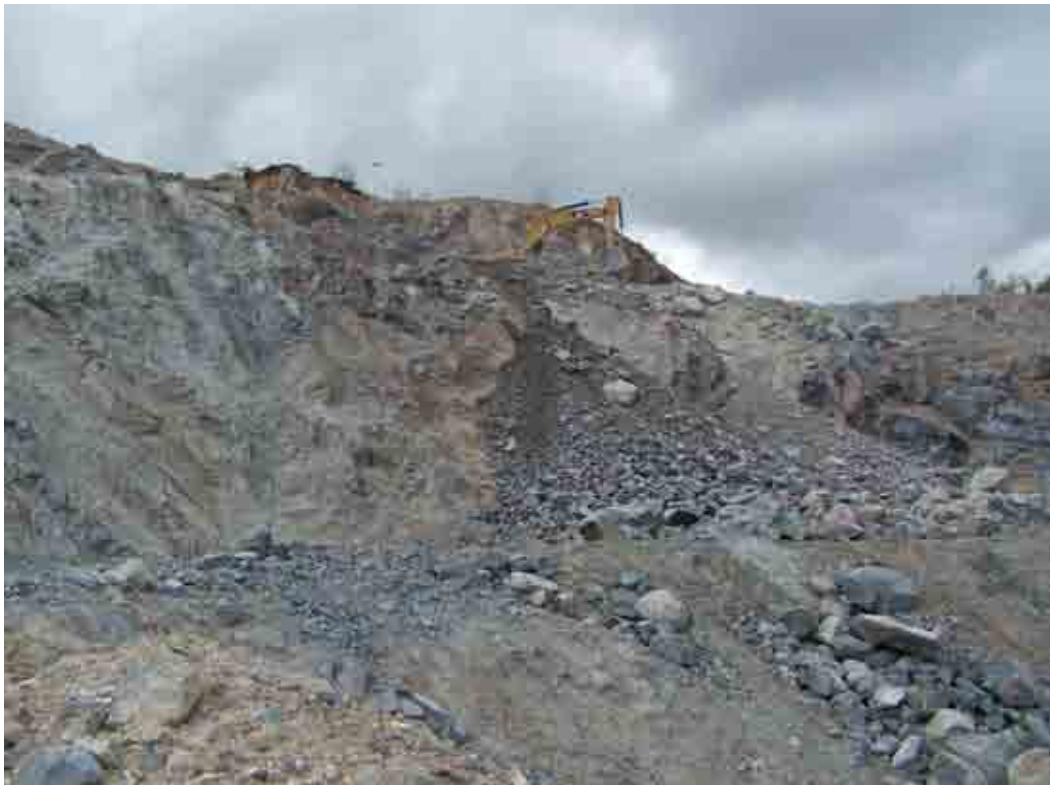
Photo 7 : Carrière IBS Kangani - Vue du front de taille supérieur montrant la juxtaposition de roche saine et altérée
