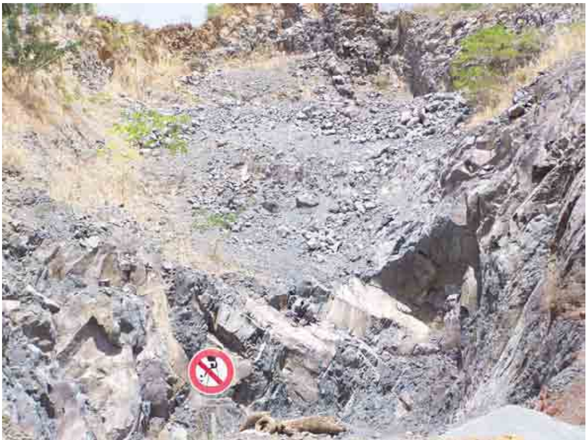
Photo 8 : Front de taille de la carrière de Mgombani ayant fourni des enrochements
