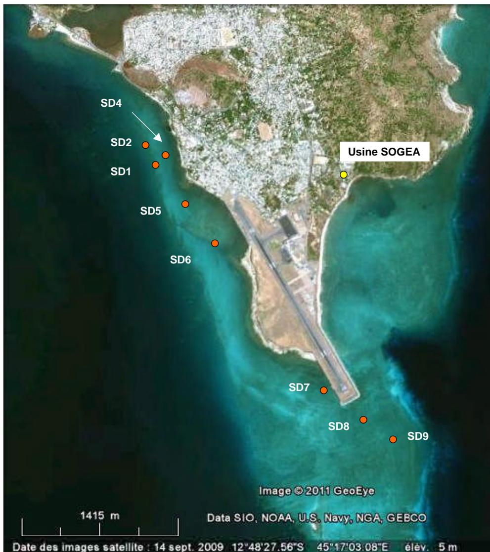
Figure 13 . vue aérienne verticale du Sud de l'île de Pamandzi et de la pointe de l'aéroport et du Nord du récif de Pamandzi : situation des forages importants réalisés à terre (usine de dessalement SOGEA, 1997) et en mer (campagne de 2006).
