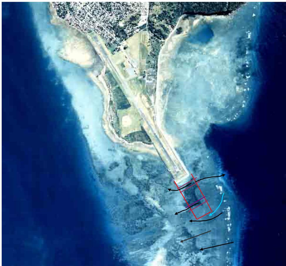
Figure 2. Pointe Sud de l'aéroport et projet d'extension de l'épi actuel de 500 m de long d'une avancée de 550-570 m sur le platier du récif de Pamandzi : proposition pour les emplacements des 2 dalots sous l'extension (THOMASSIN, mai 2011 pour SOGREAH : fond : vue aérienne IGN de 1997).
