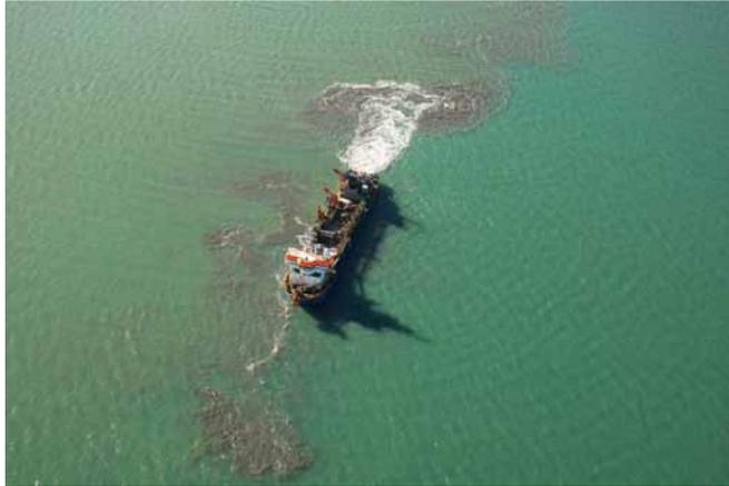
Illustration du panache turbide créée par la déverse d'une drague hydraulique
