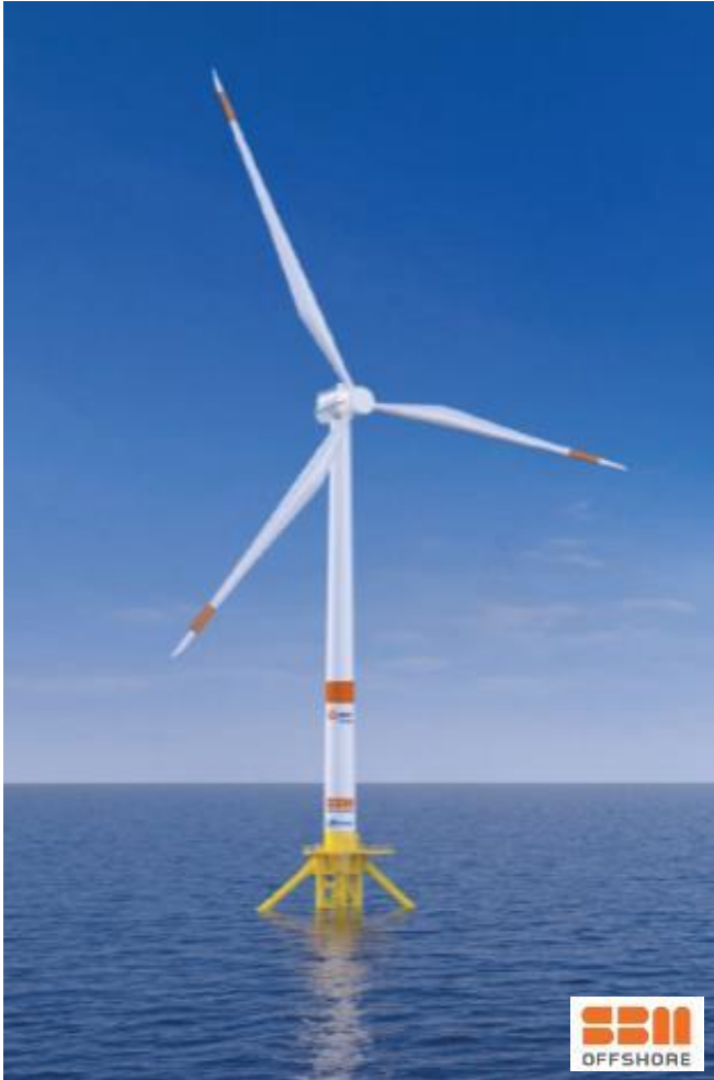
Conception par IFPEN et SBM Offshore du flotteur de Provence Grand Large
