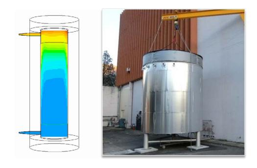
Simulation et expérimentation autour de la stabilité de la stratification thermique dans les réservoirs d'eau (apport/extraction)
