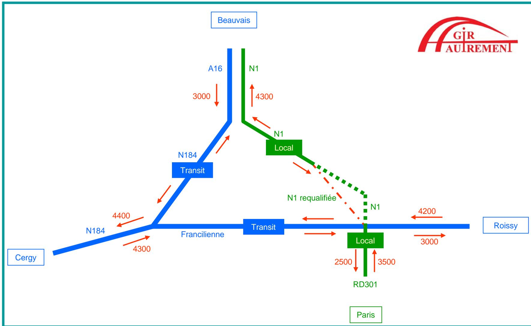
Agir Autrement souhaite que la maîtrise d'ouvrage évalue la répartition des flux sur la boucle à l'aide de ses propres modèles. Les flux entrants et sortants du nœud sont ceux qui ont été retenus dans la synthèse de l'étude de trafic réalisée par la maîtrise d'ouvrage pour 2015.
