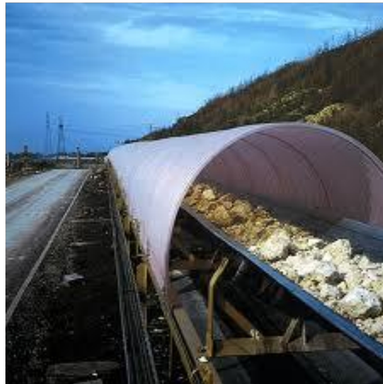
Bande transporteuse capotée pour une maîtrise du bruit
