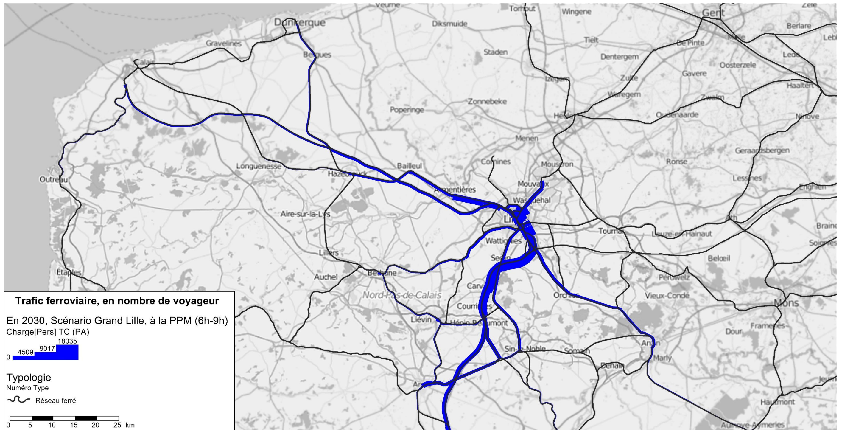
Figure 15 : Trafic ferroviaire en situation de projet 2030, PPM (6h-9h)
