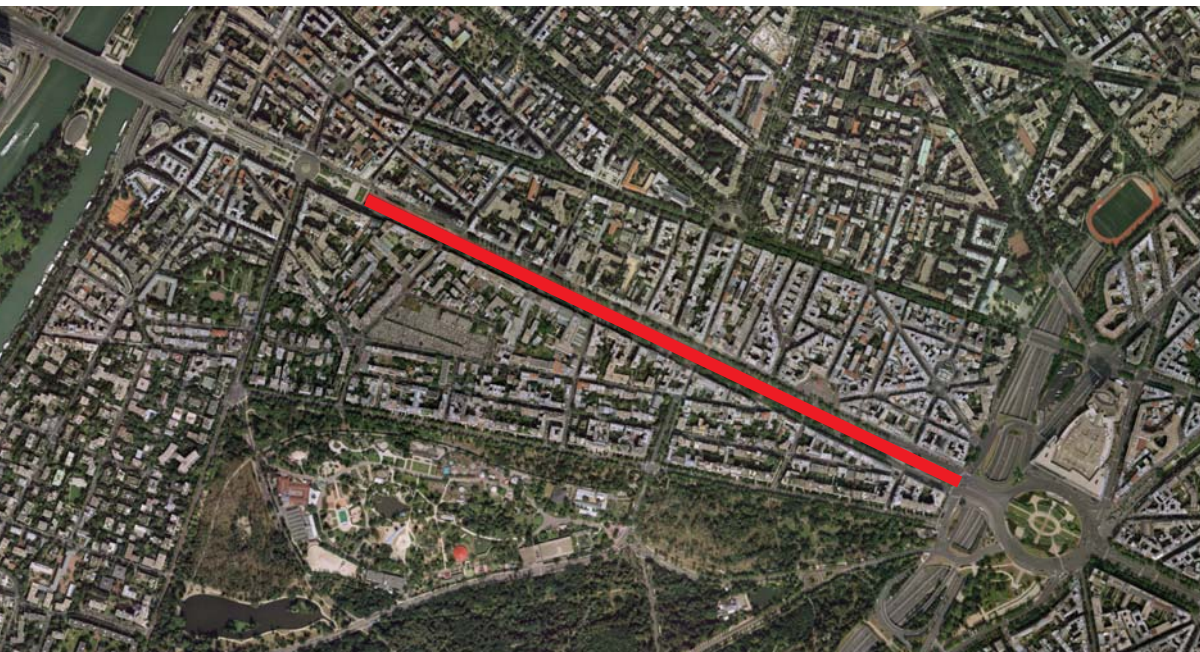
Le projet soumis au débat prévoit la mise en souterrain de l'avenue Charles-de-Gaulle sur 1 385 mètres, du carrefour Madrid à la porte Maillot.
