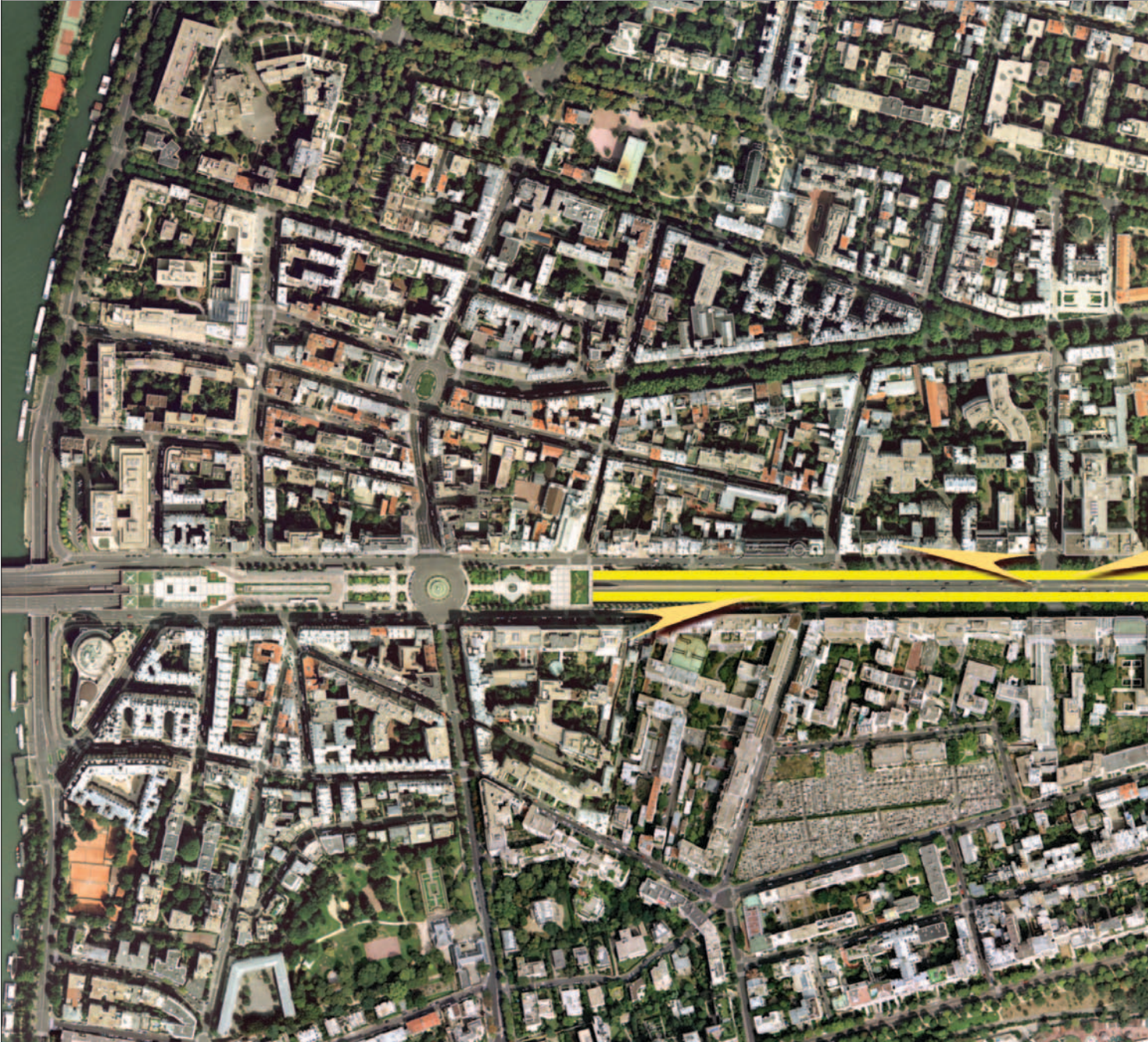
La portion de la RN13 mise en souterrain figure en jaune sur la carte. Les entrées-sorties des tunnels sont représentées en orange.
