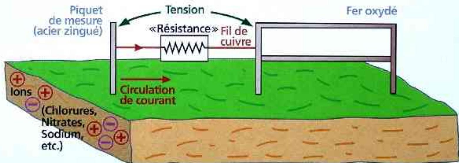
Précision importante : la mesure de tension continue peut être perturbée par l'utilisation d'électrodes métalliques
