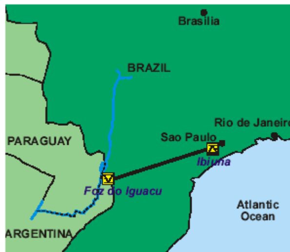
Figure 3-88 : réseau HVDC au Brésil entre la centrale de Itaipu et la ville de São Paolo
