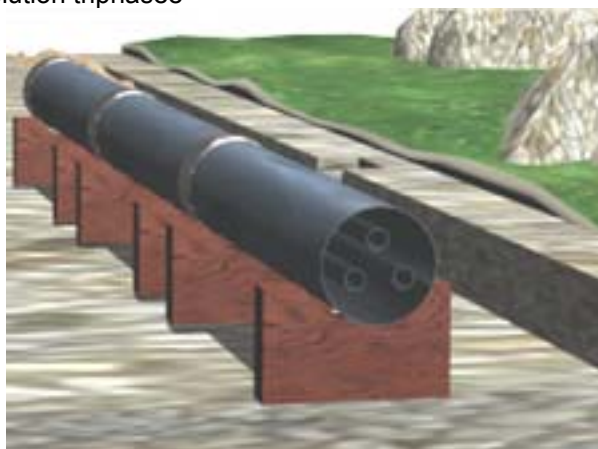
Figure 3-71: Vue de modules triphasés CIG pré-assemblés.
