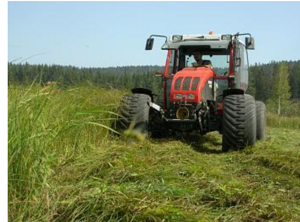
Maison de la réserve naturelle du lac de Remoray Équipement pour fauche tardive sur zone humide (Marais, tourbière)
