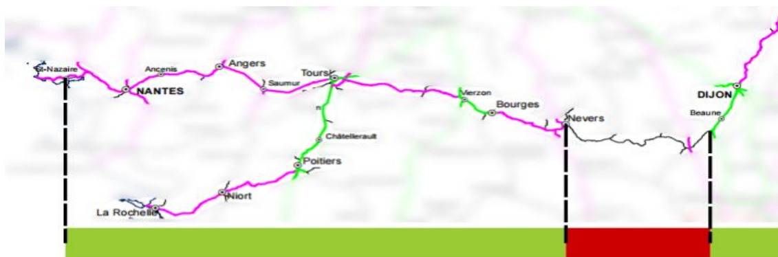
Figure 1 - État de l'électrification sur l'axe VFCEA, en rouge Nevers-Chagny, seule section non-électrifiée
