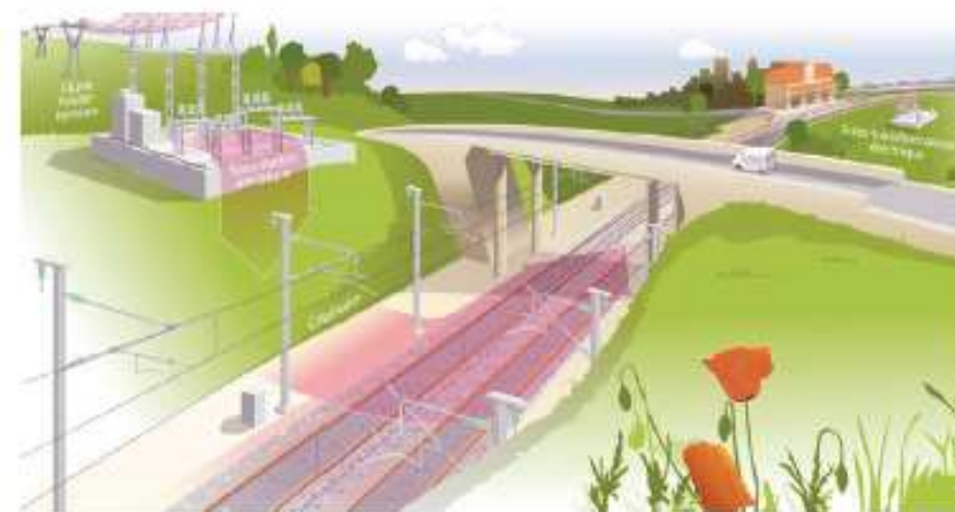
Schéma illustrant les équipements d'électrification d'une voie ferrée.
