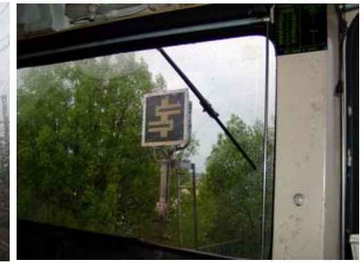
Sur Paris Dreux, le changement de la tension du courant
