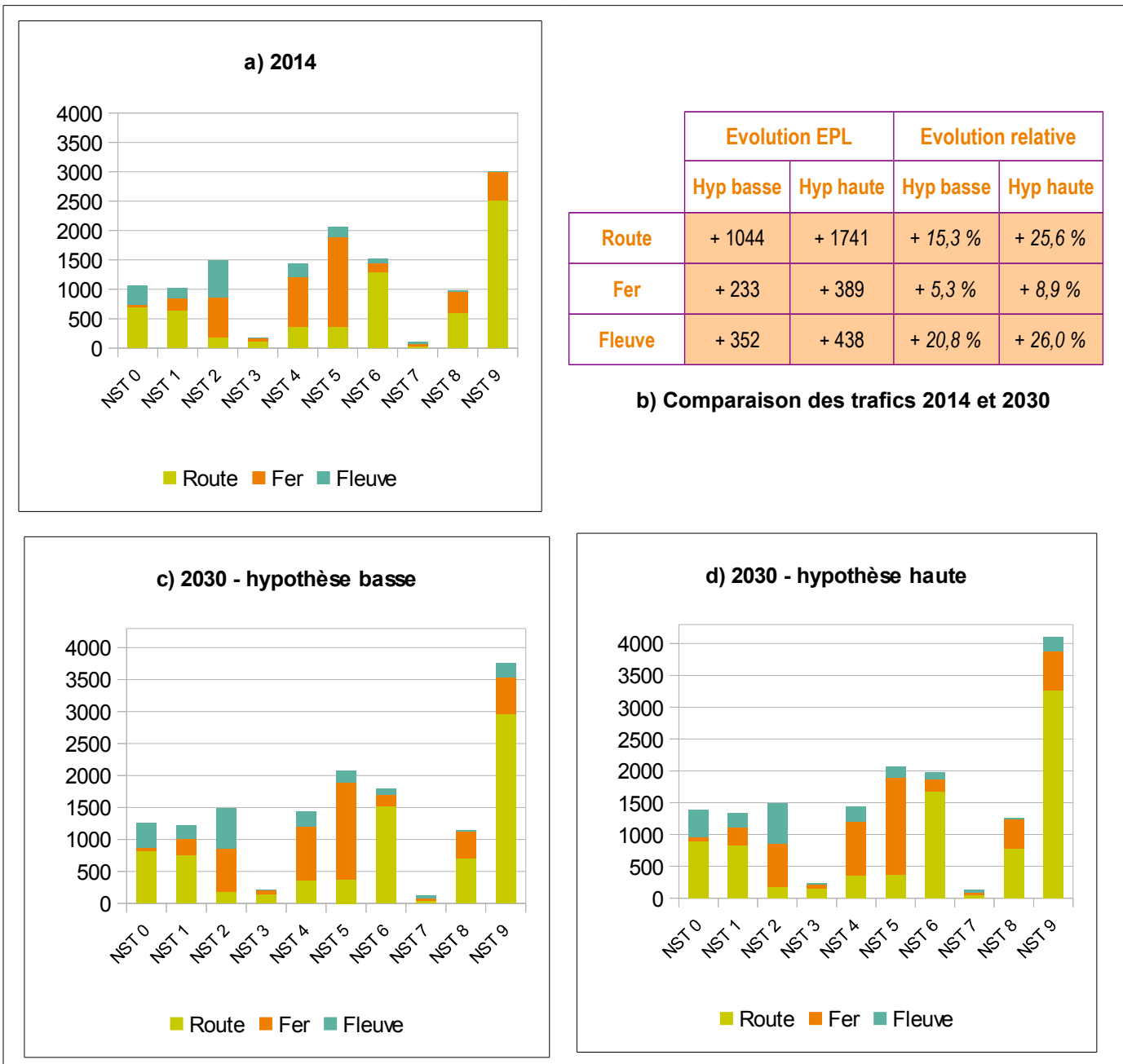
Illustration 2: Evolution des trafics d'échange et de transit sur l'axe de l'A31, par mode et par NST, dans le cadre du scénario 1 « Parts modales constantes par NST » : a) Trafics en 2014; b) Évolutions relatives et absolues ; c) Trafics en 2030 dans l'hypothèse de trafic basse; d) Trafics en 2030 dans l'hypothèse de trafic haute.
