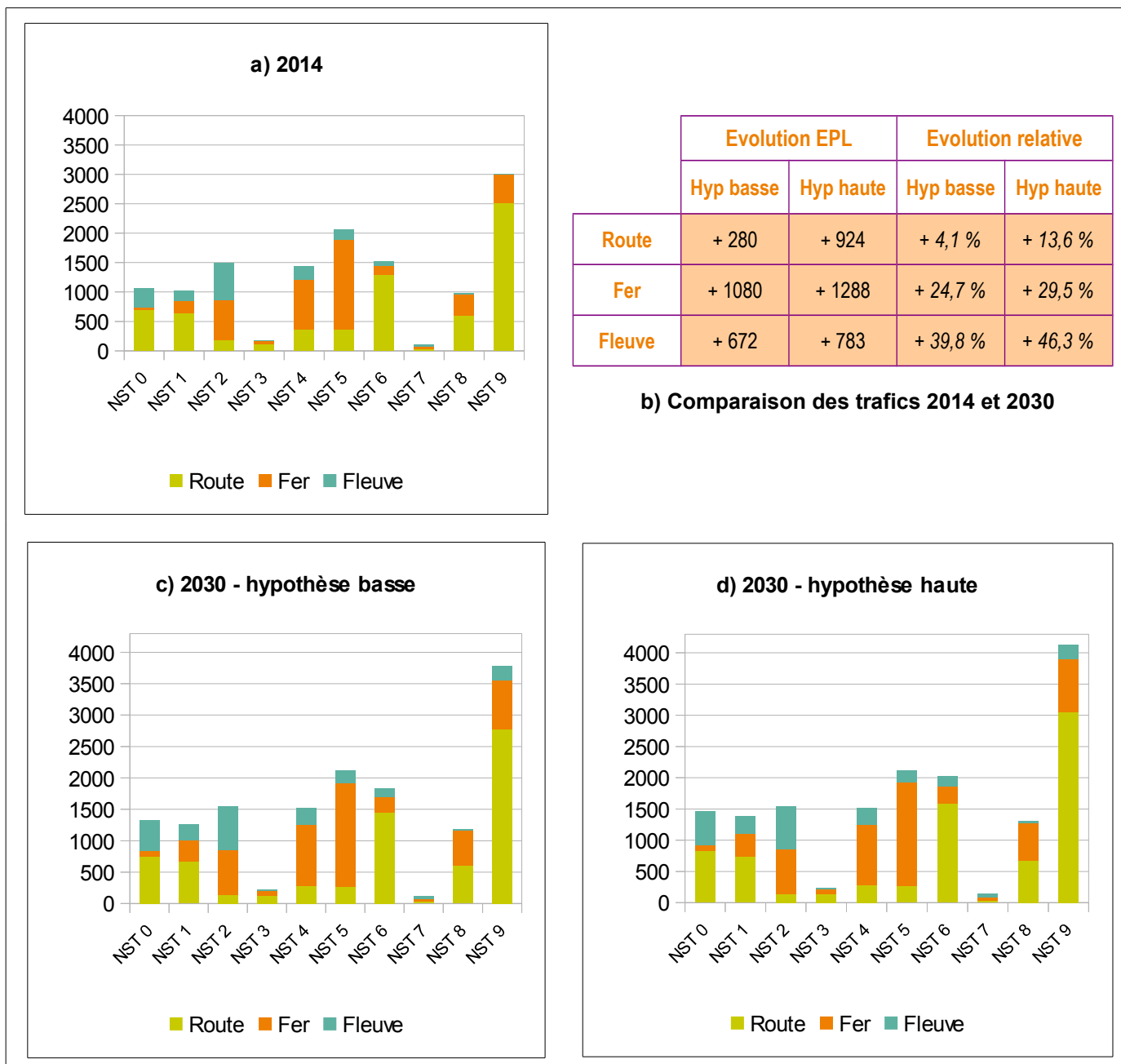
Illustration 3: Evolution des trafics d'échange et de transit sur l'axe de l'A31, par mode et par NST, dans le cadre du scénario 2 « Report modal » : a) Trafics en 2014; b) Évolutions relatives et absolues ; c) Trafics en 2030 dans l'hypothèse de trafic basse; d) Trafics en 2030 dans l'hypothèse de trafic haute.
