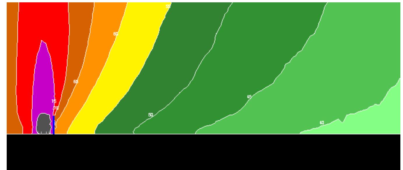
Même situation avec écran absorbant de hauteur 2 m
