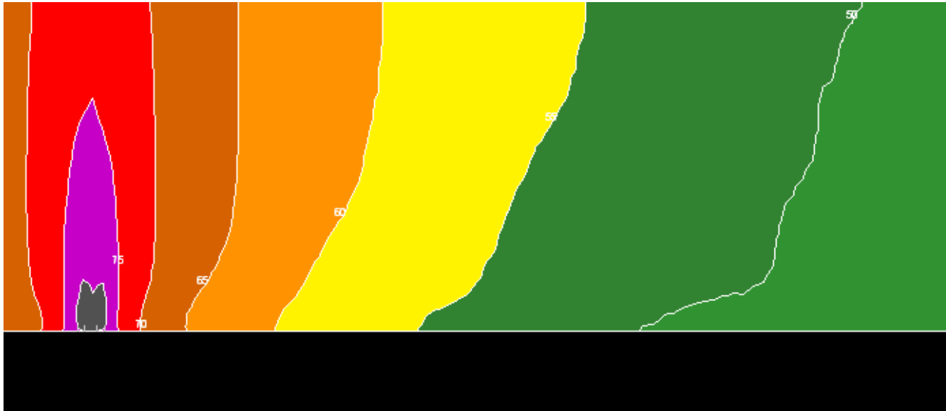
Route au TN – 1340 véhicules/heure à 110 km/h dont 7 % de PL 4 – échelle des hauteurs dilatée 10 fois Intervalle entre isophones = 5 dB(A)
