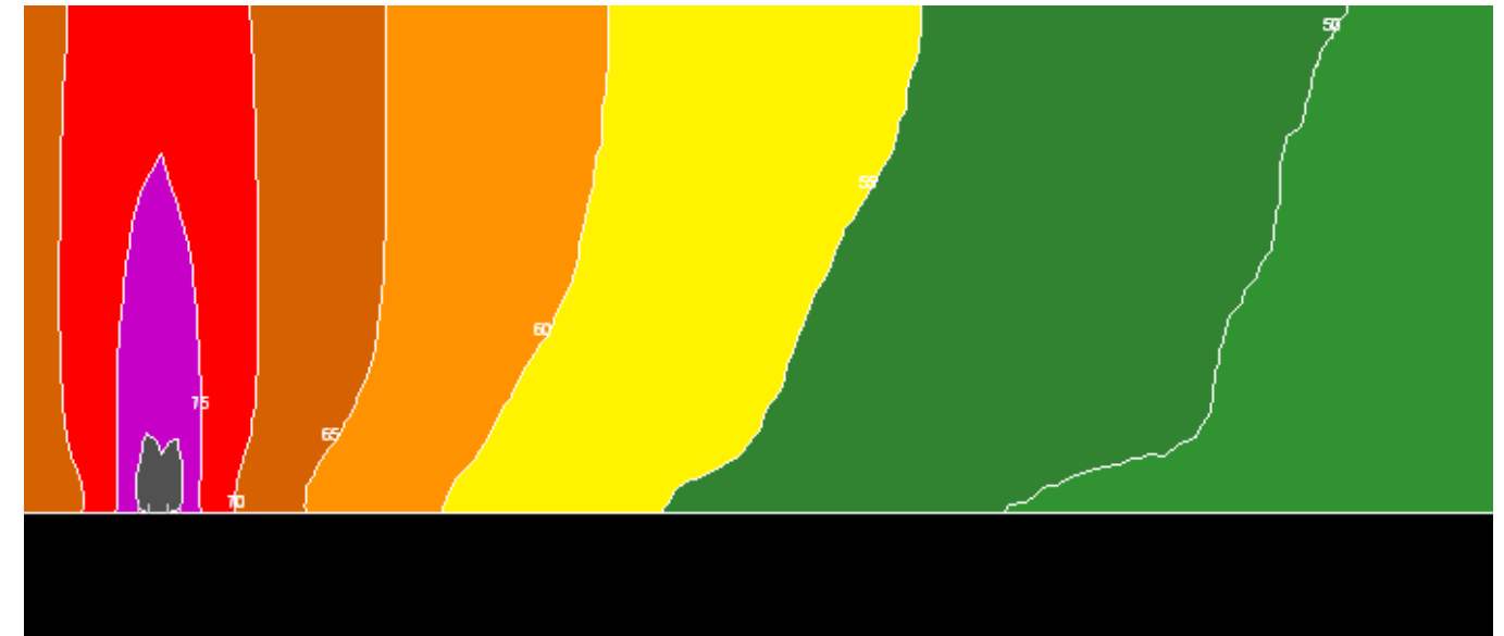
Route au TN – 1340 véhicules/heure à 110 km/h dont 7 % de PL – échelle des hauteurs dilatée 10 fois
