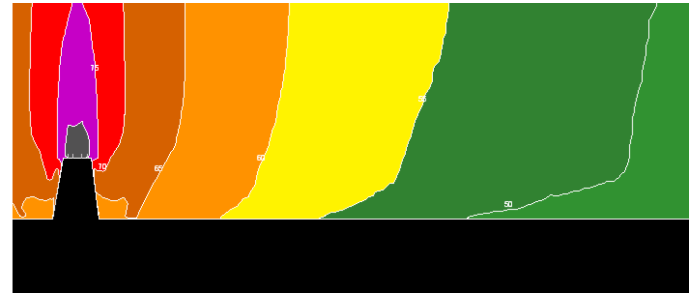
Route sur remblai hauteur 4 m – 1340 véhicules/heure à 110 km/h dont 7 % de PL – échelle des hauteurs dilatée 10 fois
