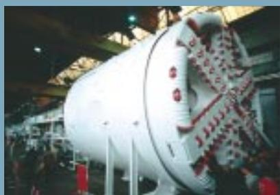
Le tunnelier est un outil de forage, mais aussi une véritable usine souterraine qui assure simultanément les différentes fonctions de réalisation d'un ouvrage de
