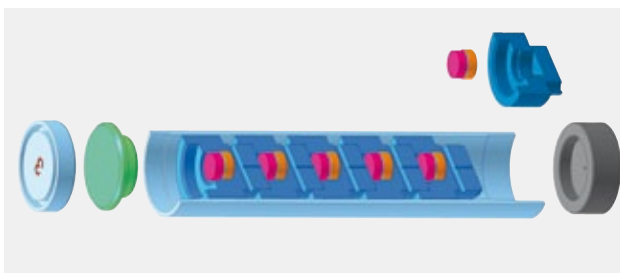
Schéma du dispositif d'irradiation expérimental pour la transmutation en couvertures.
