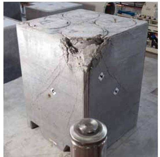
Démonstrateur de conteneur de stockage MA-VL après un essai de chute.
