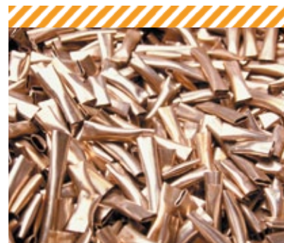
Exemple de déchets MAVL (moyenne activité à vie longue) - Embouts de combustibles.
