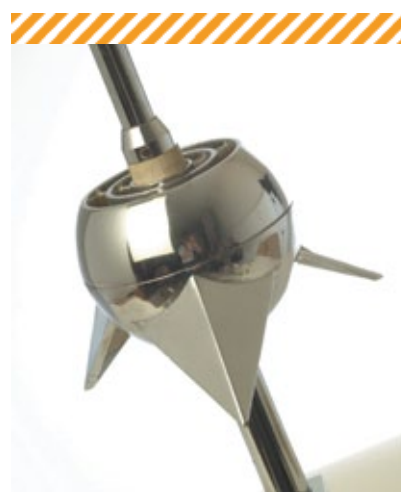
Jusqu'à la fin de années 1990, des sources scellées contenant du radium ou de l'américium ont été ajoutées sur certains paratonnerres. Une fois démontés ils doivent être collectés et gérés en tant que déchets radioactifs de type FAVL.
