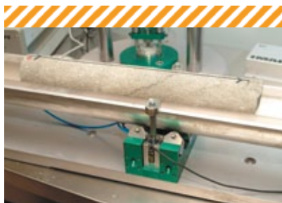
Caractérisation des propriétés mécaniques de la roche sur échantillon de carotte.
