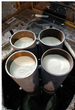
Préparation du moule de coulée de l'insert en fonte
