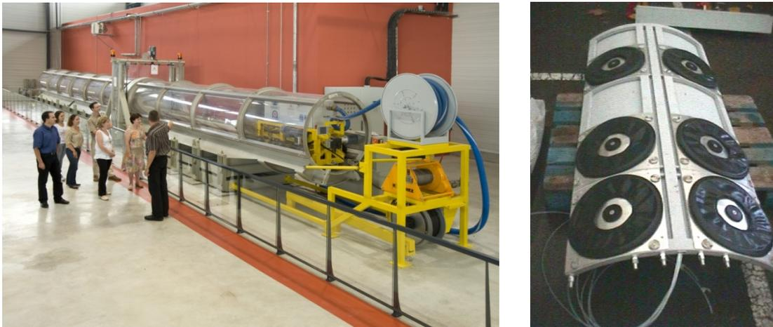
Figure 2.3-8 Démonstrateur de maintenance de colis de combustibles usés, présenté au public à l'Espace technologique du Centre de Meuse/Haute-Marne (à droite, système de coussins d'air disposé sous le colis de combustibles usés à quatre assemblages pour permettre la translation horizontale)
