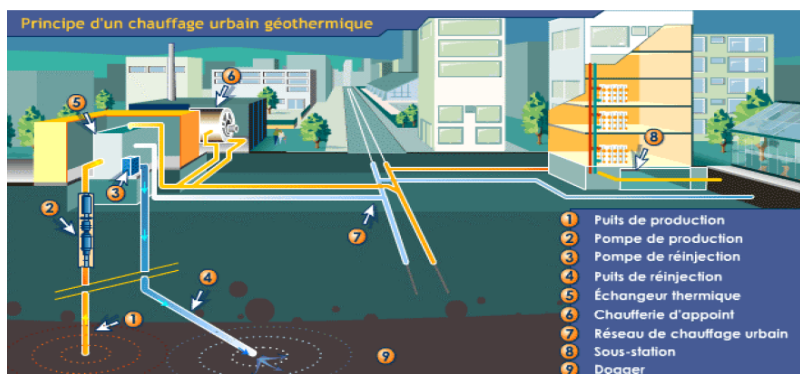
Figure 2 : Schéma d'une installation de réseau de chaleur urbain géothermique (tel qu'existant en région parisienne) (source : PPI chaleur 2009 – 2020)
