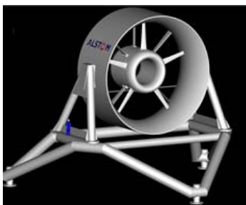
Figure 1: Démonstrateur hydrolien (Source : Alstom)
