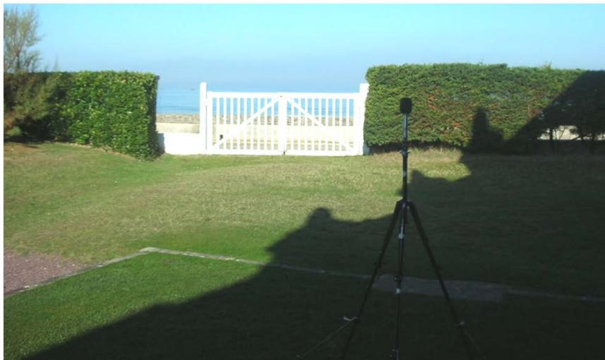
Photographie du point de mesure PF 1 : le sonomètre (microphone) est positionné sur un trépied à l'extérieur, en façade de l'habitation
