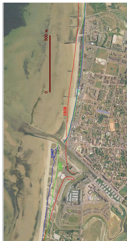
Superposition de la photographie aérienne de 2006 et des traits de côte de 1808, 1892 et 1947 (ACTIMAR)
