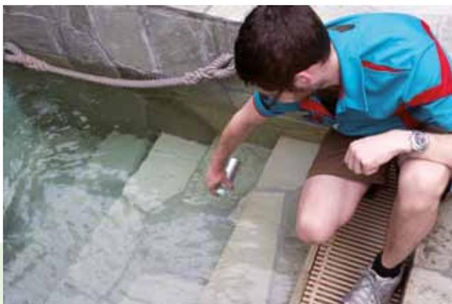
Contrôle de la qualité de l'eau de baignade : prélèvement pour analyse
