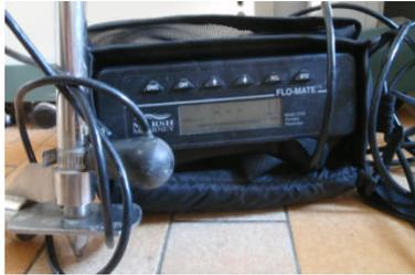
Mesure des vitesses de l'eau au courantomètre électromagnétique sur canne inox et Flowmètre FLO MATE 2000/CM
