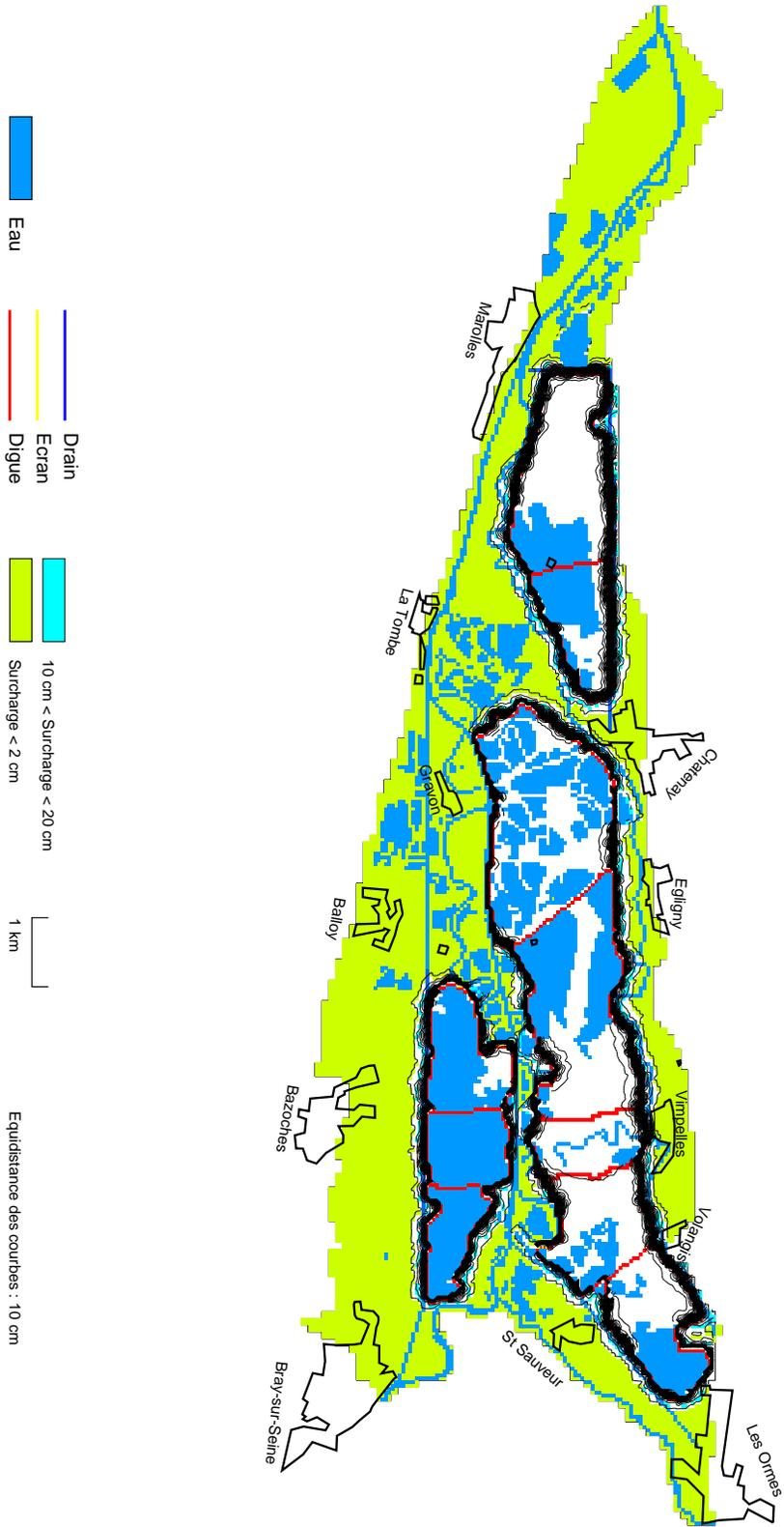
FIG. 9.102: Simulation 1 : surcharges hydrauliques calculées dans les Alluvions, 4 jours après le début du remplissage des casiers ; 1 jour avant la fin du remplissage des casiers. Hypothèses : drain Nord et drain Sud, écrans, rabattements de nappe (protection contre les inondations de cave).
