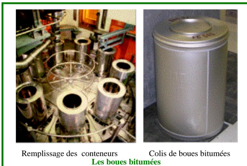
Certains déchets liquides d'exploitation peuvent être **bitumés** plutôt que cimentés. Cette technique est surtout utilisée pour les déchets qui se présentent sous forme de boues. Ces boues sont mélangées à du bitume à une température d'environ 150°C. Le mélange est ensuite coulé dans un conteneur en acier inoxydable.
